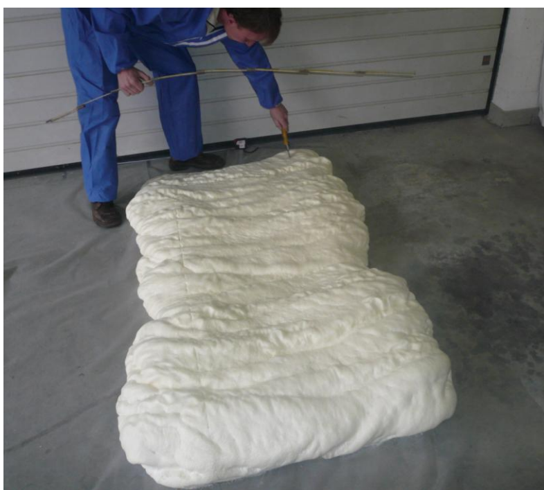
Photo 1 : Echantillon après projection et avant découpe
